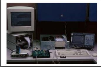
*Contrôle & acquisition du rythme cardiaque par mesure de l'opacité du lobe de l'oreille. ( ensemble conçu au tour d'un ST6230 de Thomson)
